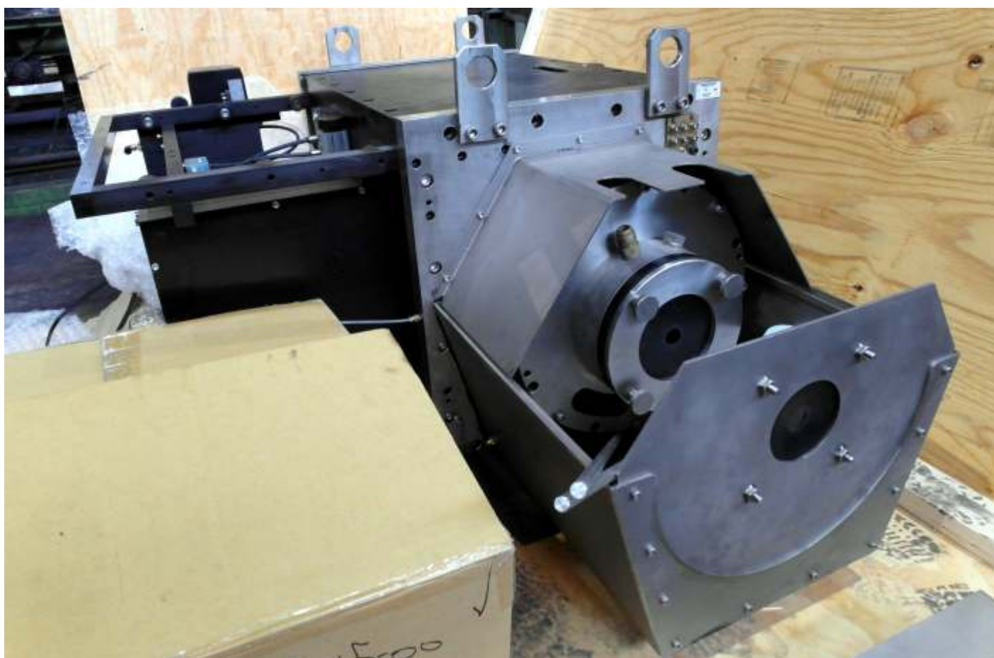
Zgoraj: Shematski prikaz 100-odstotne pokritosti preseka palice s pomočjo UZ-žarkov, Spodaj: Izgled rotirajoče MAC UZ naprave
