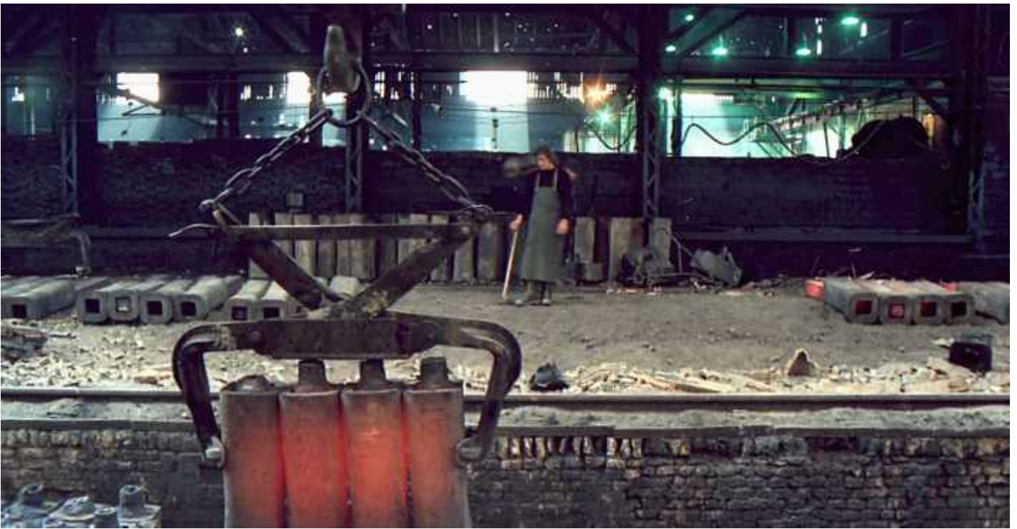
Martinarna - praznenje kokil z ingoti, okoli 1970, fotografija, arhiv podjetja
